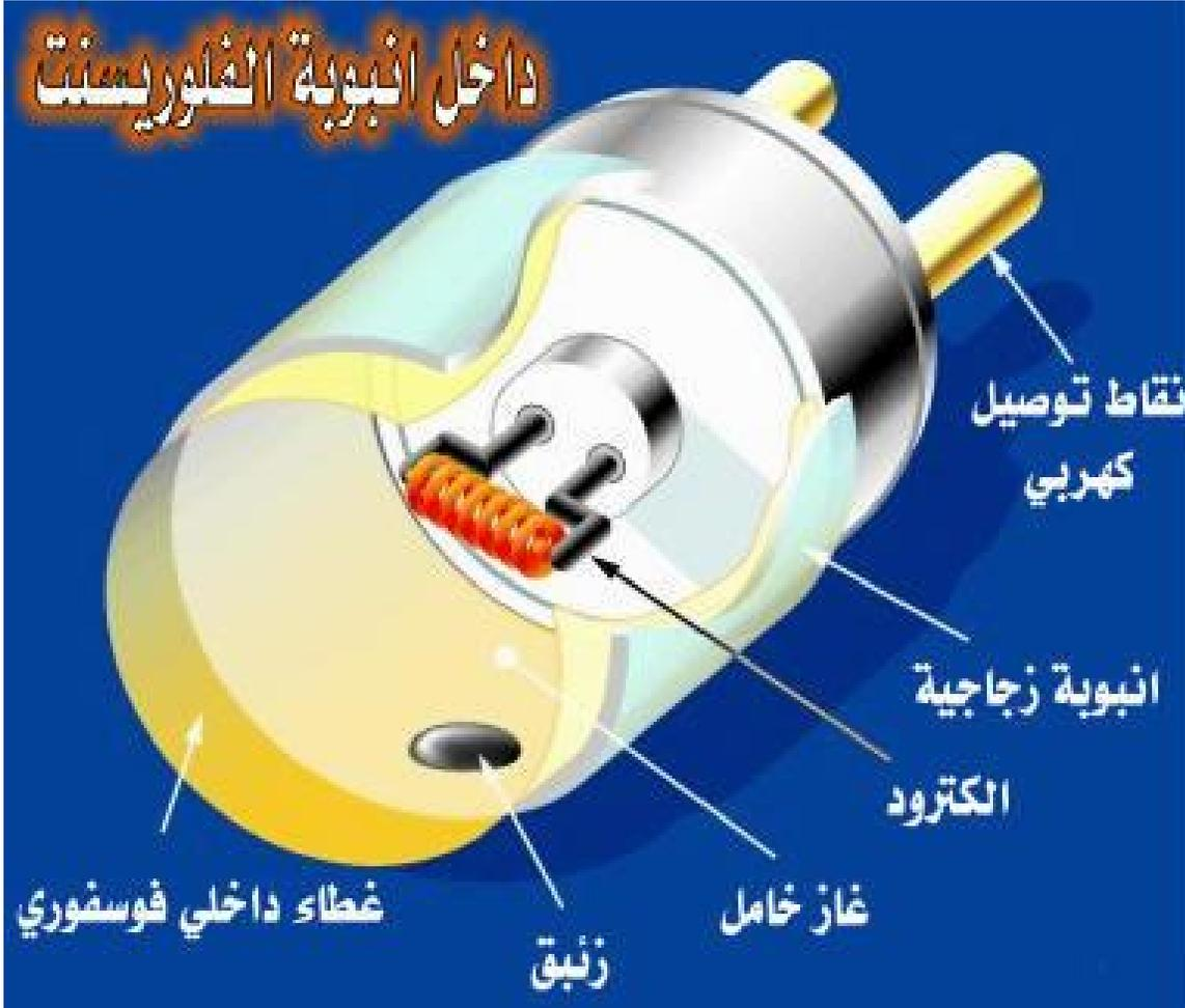
كذلك تغطي سطح الانبوبة الداخلي طبقة من مادة فسفورية. يوجد على طرفي الانبوبة إلكتروود للتوصيل الكهربائي وفي داخل الأنبوبة يتصل الإلكتروود بفتيلة حرارية تطلق الإلكترونات عندما تسخن بمرور التيار الكهربائي بها.
